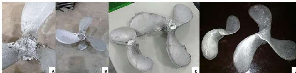
Figura 3 - Defeitos de fundição (A) e (B)/Retirada das rebarbas (C) e (D)
