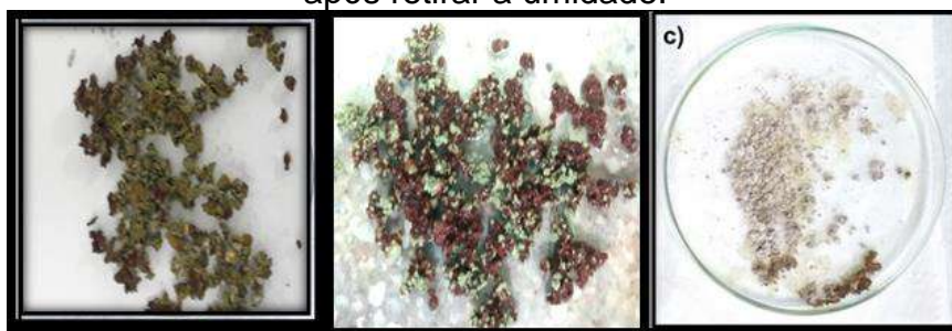
Figura 1. a) Amostra após a síntese. b) Amostra com umidade. c) Amostra após retirar a umidade.
