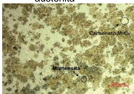
Figura 1: Microestrutura do RD com Martensita com eutético de carbetos e austenita
